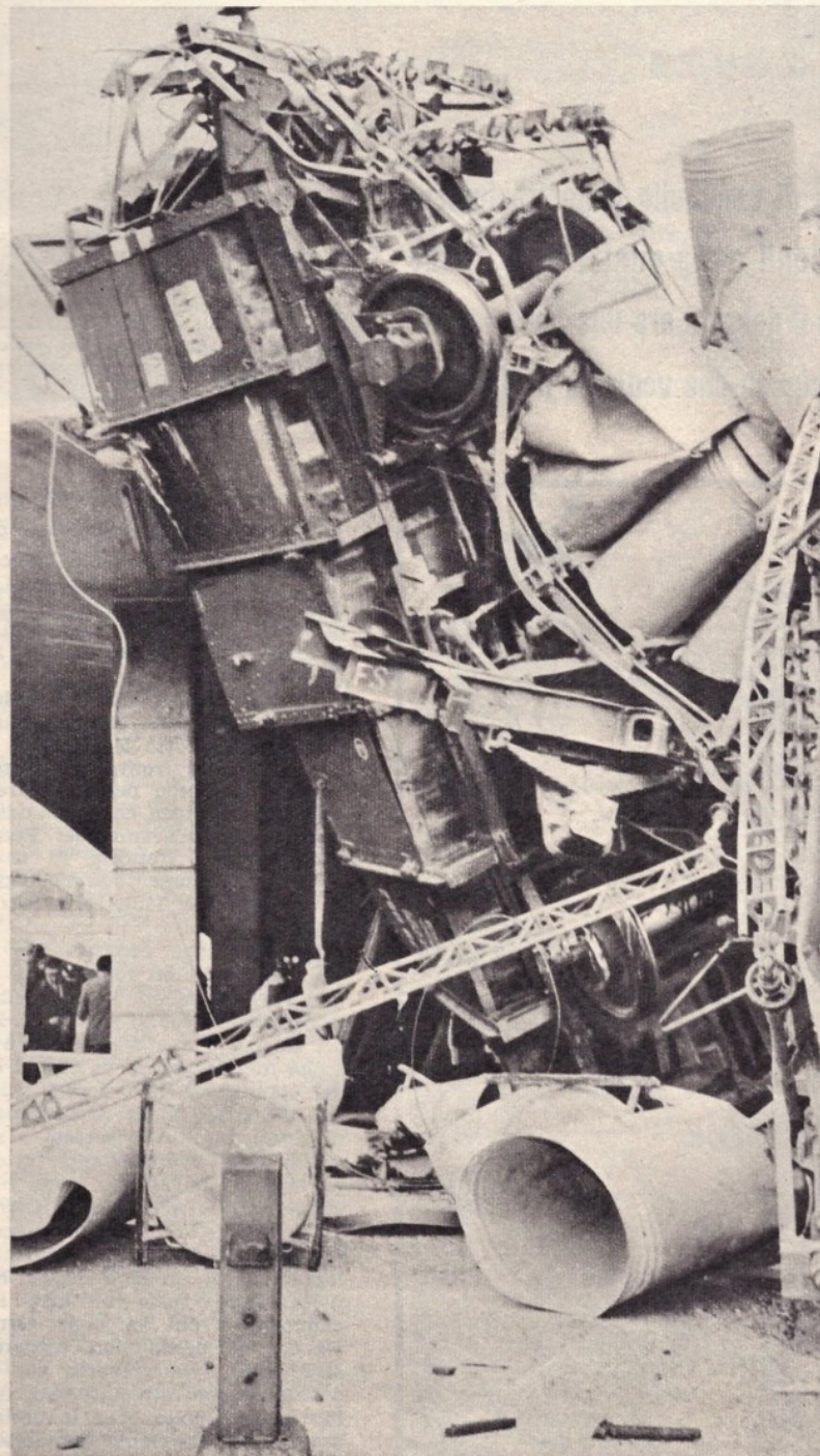
Particolare del vagone che s'è impennato. Il locomotore del treno investitore, del peso di 85 tonnellate, ha sventrato la vettura di coda del convoglio passeggeri.
